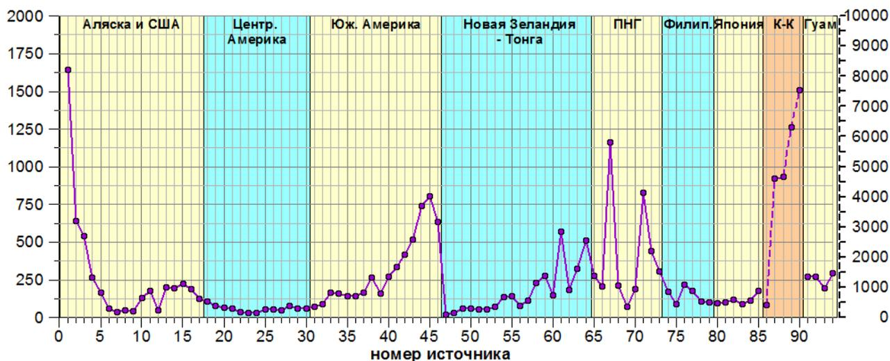
Рис. 6. Интегральная характеристика воздействия различных групп очагов цунамигенных землетрясений на защищаемый участок Дальневосточного побережья РФ, полученная с использованием двухминутной сетки. На горизонтальной оси отложен номер очага, на левой вертикальной – интегральная характеристика, на правой – эта же характеристика в другом масштабе для очагов Курило-Камчатской группы.
