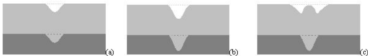
Рисунок 2. Формирование трещины и начального возмущения свободной поверхности: (а) – t = 0.05 s, (б) – t = 0.1 s, (в) – t = 0.18 s.
